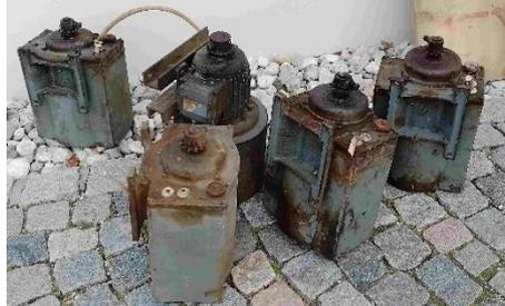
Glockenläutemotoren mit Steuergehäuse und Elektroleitungen für die vier Glocken im Glockenturm unserer ehrwürdigen St. Martinskirche vor. Die Arbeiten waren nicht „ohne“, angesichts der Enge im Kirchturm, der kurzen steilen Holztreppen und einer langen Eisensteigleiter auf 30 Meter Höhe direkt unter der Turmzwiebel. Die alten Motoren, je vier bis sechs Zentner schwer mussten zuerst händisch abgeseilt werden und die neuen Motoren ebenso händisch hinaufgezogen werden.
